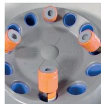
3. Coloque los tubos en la centrifugadora
